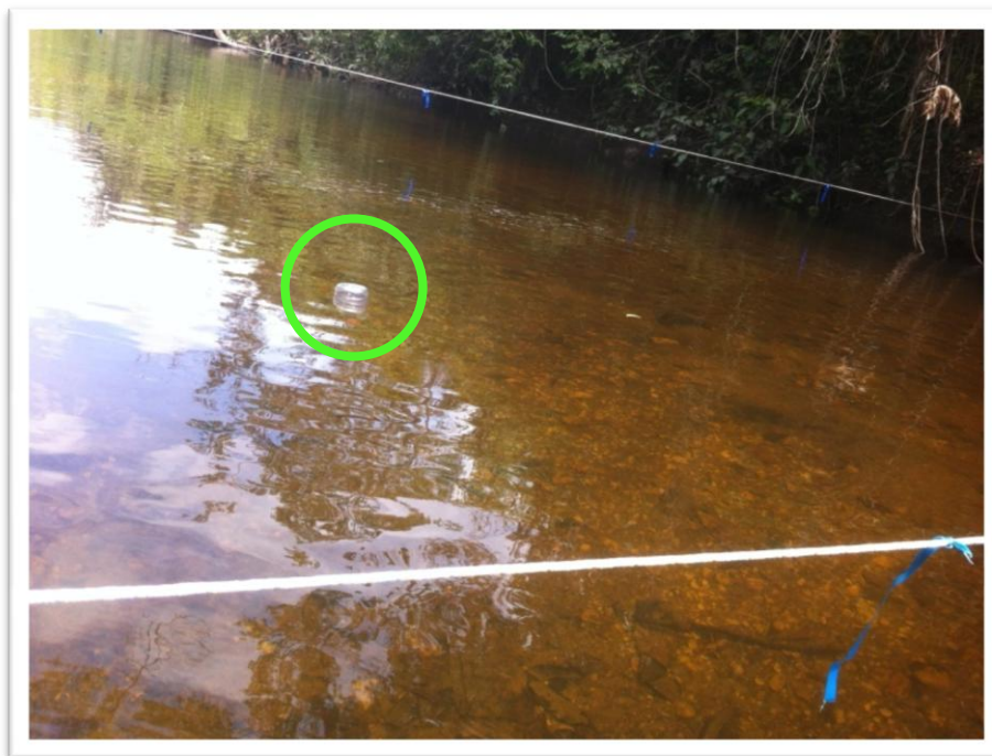
Figura 10. Objeto flutuador para medição do tempo de deslocamento.
