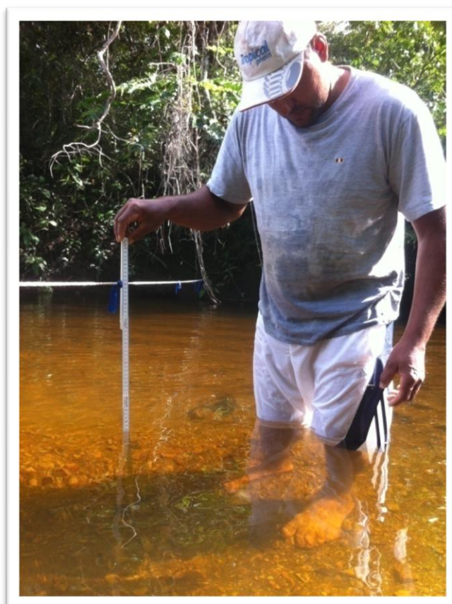
Figura 9. Medida da profundidade do rio em diversos pontos da seção transversal.
