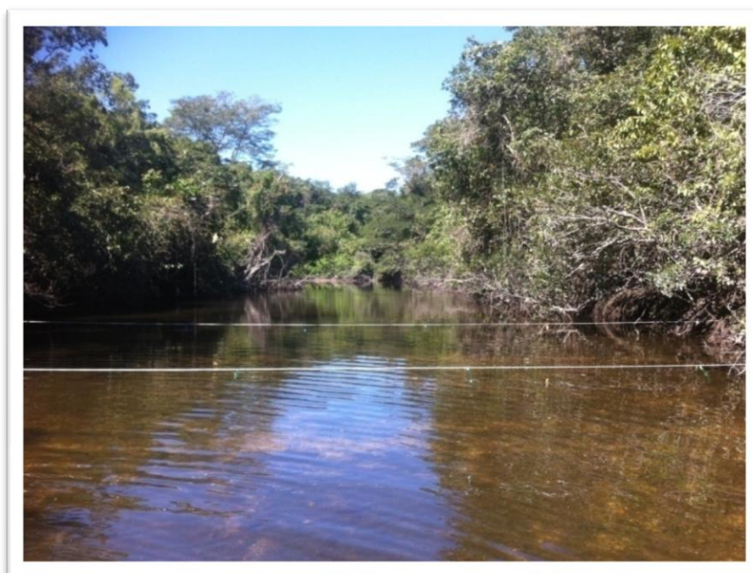
Figura 8. Seções transversais para medição de vazão.
