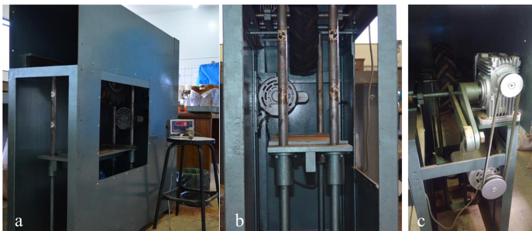
FIGURA 3. Vistas do simulador linear de tráfego: a) Perspectiva; b) Lateral esquerda; e c) Lateral direita.
