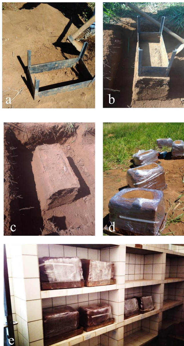
FIGURA 2. Retirada de amostras indeformadas: a) Molde com medidas para retirada do bloco; b) Escavação do bloco de solo; c) Bloco escavado e desprendido; d) Blocos retirados, plastificados e identificados; e) Blocos armazenados na câmara úmida.
