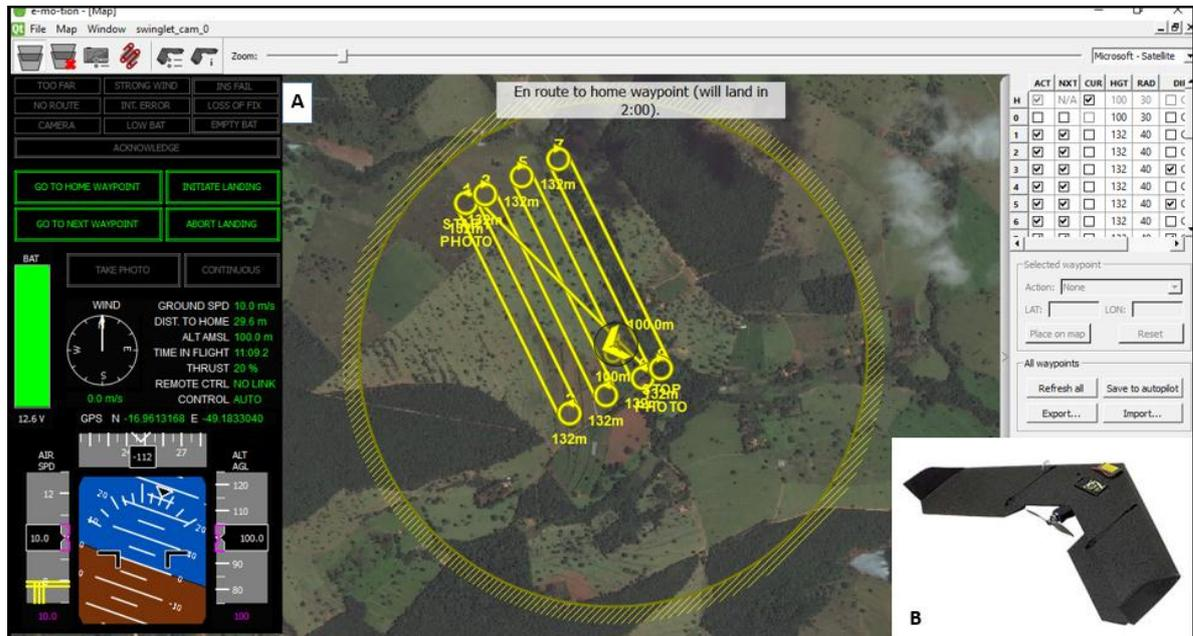
**Figura 10.** (A) Plano de voo no software e-mo-tion. (B) Swinglet Cam, equipamento utilizado nesta pesquisa (Fonte: LapiG/UFG).
