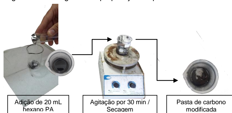
Figura 11 - Fluxograma da preparação da pasta de carbono modificada.
