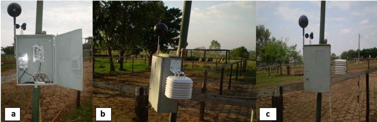
FIGURA 7. (a) (b) (c) Posicionamento da miniestação meteorológica, com os sensores alocados no ambiente externo.
