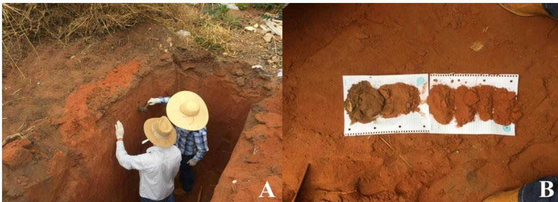
**Figura 7.** A. Caracterização de horizonte utilizando martelo de borracha e canivete. B. Uso de papel branco para auxílio na caracterização dos horizontes do solo.
