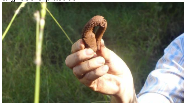
Figura 52. P3 – Cilindro textura muito argiloso e plástico
