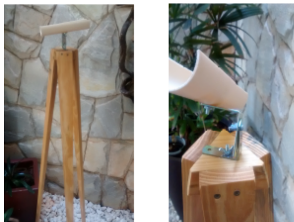
Figura 18: Fotos do tripé - (a): vista em perspectiva; (b): detalhe para o encaixe da luneta.
