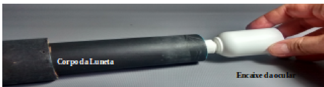
Figura 17: Vista lateral da luneta com o encaixe da ocular.
