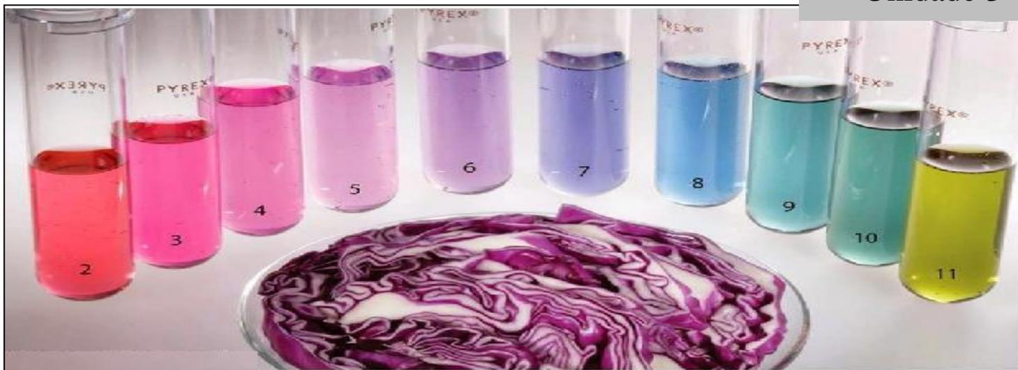
**Figura 27-** Escala de pH construída com extrato de repolho roxo.
