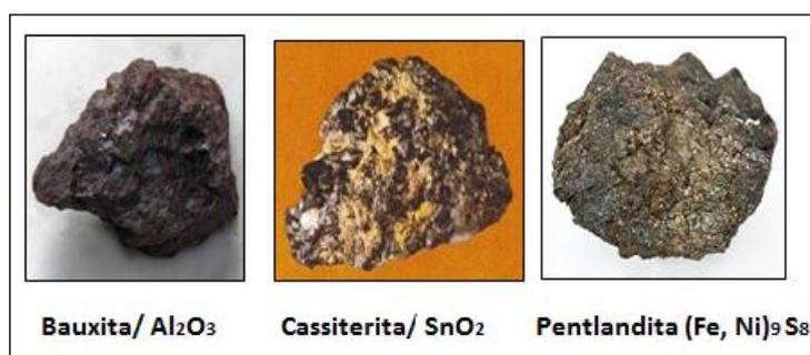
**Figura 14:** Minerais bauxita, cassiterita e pentlandita e suas composições químicas.
