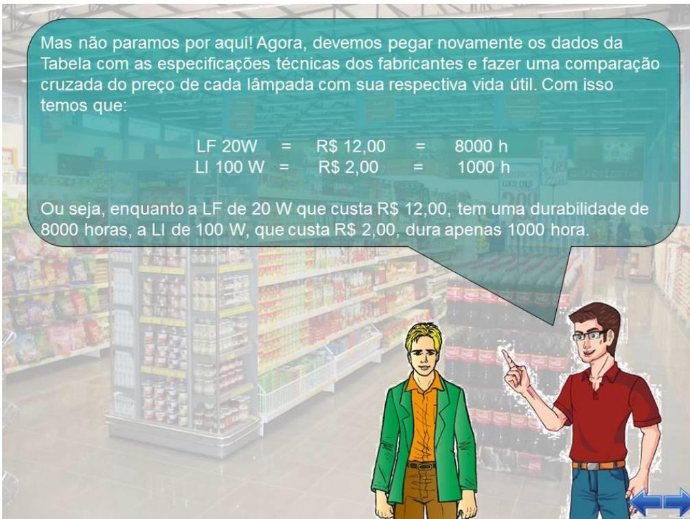
A lâmpada fluorescente proporciona uma economia de 80% de energia elétrica quando comparada com uma lâmpada incandescente de 100 W.
