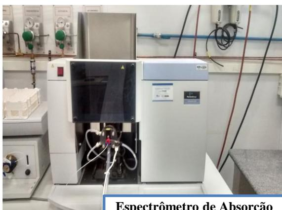
Espectrômetro de Absorção Atômica com Chama (FAAS)
