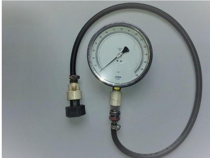
FIGURA 26. Manômetro analógico com escala de 0 a 100 mH<sub>2</sub>O.
