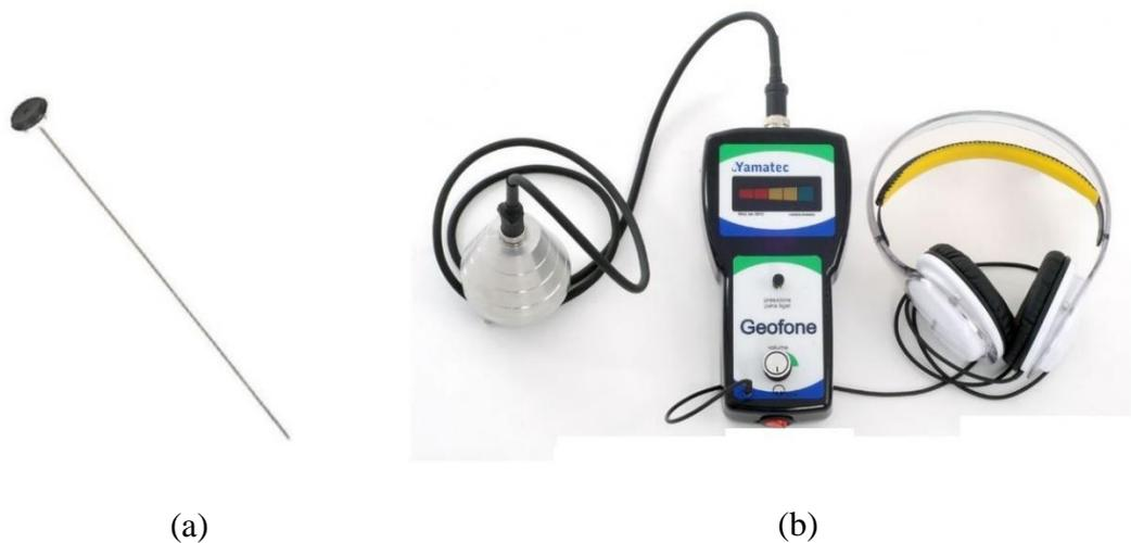
FIGURA 30. Haste metálica de escuta (a) e geofone eletrônico (b).
