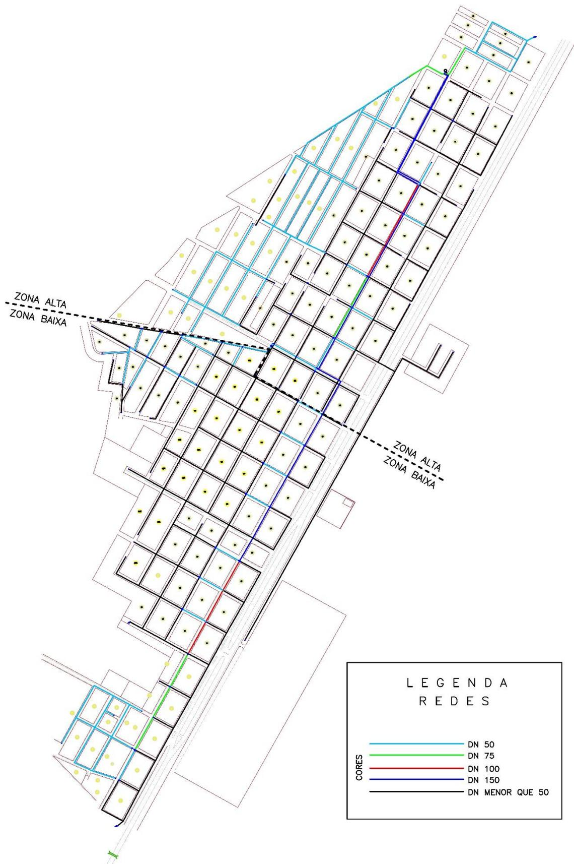
FIGURA 13. Configuração das redes de distribuição de água tratada de Cocalzinho de Goiás.
