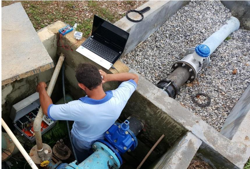
FIGURA 17. Coleta de dados de vazão e pressão na saída do reservatório apoiado.
