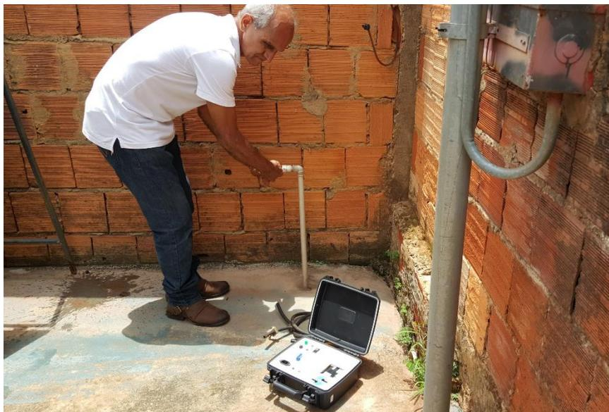
FIGURA 18. Coleta de dados de pressão em ponto crítico.
