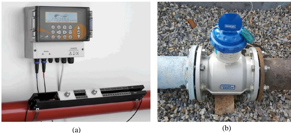
FIGURA 28. Macromedidores (a) ultrassônico e (b) eletromagnético.
