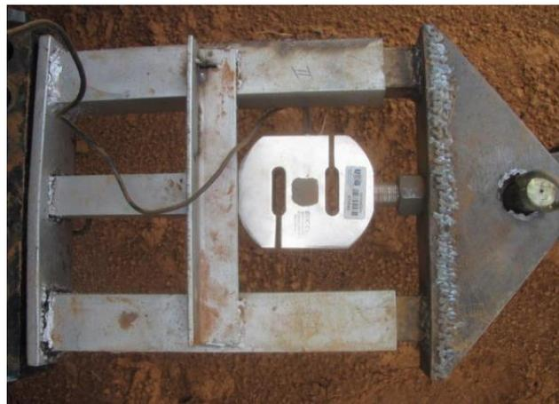
FIGURA 4. Suporte e célula de carga utilizada entre os tratores para determinar a carga aplicada à barra de tração.
