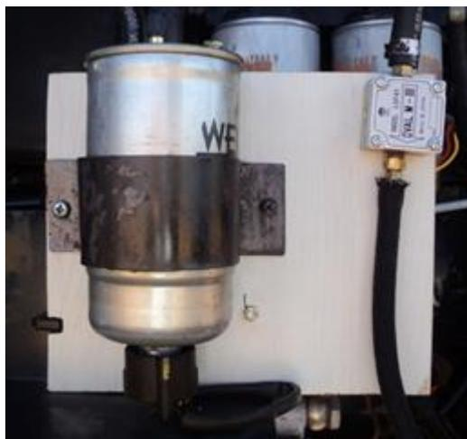
FIGURA 6. Esquema de instalação do fluxômetro utilizado no trator de ensaio.
