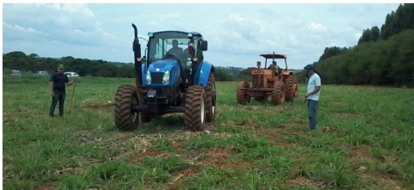
FIGURA 2. Trator de ensaio e trator de frenagem utilizado no ensaio de campo.
