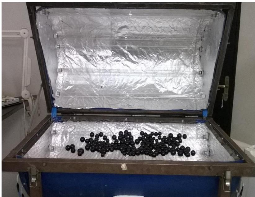
FIGURA 2 Protótipo irradiador com as jabuticabas no Laboratório de Secagem e Armazenamento de Produtos Vegetais, UEG-CCET.
