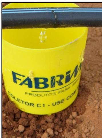
**FIGURA 6.** Coletor utilizado na determinação da uniformidade da vazão.
