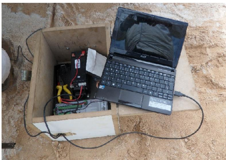
FIGURA 16: Equipamentos utilizados na aquisição de dados do ensaio de resistência superficial: notebook, cabo serial e datalogger.
