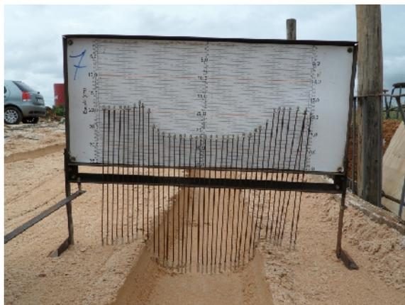
FIGURA 12: Medição do recalque da trilha de roda formada pela passagem da carga. O equipamento utilizado foi um perfilômetro de barras.
