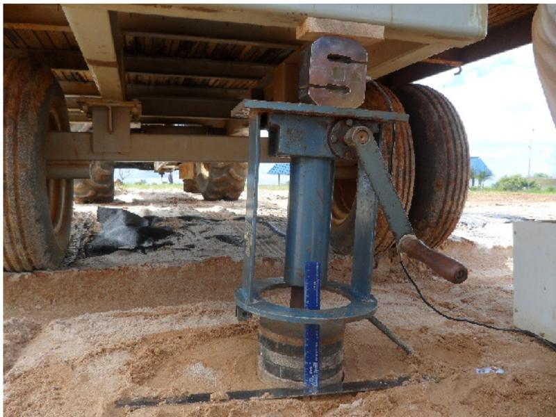
FIGURA 15: Equipamento utilizados no ensaio de resistência superficial do solo: um macaco de rosca, pistão de 150 mm de diâmetro, régua para medição da profundidade e célula de carga.
