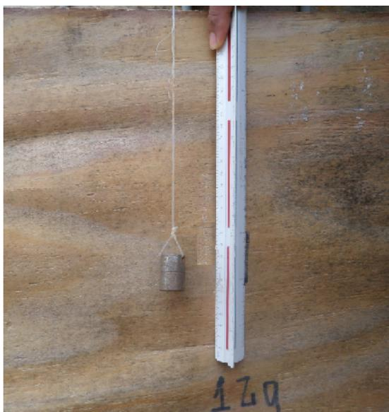
FIGURA 14: Sistema de medição do deslocamento dos geossintéticos. A régua é a parametrização das medidas no software AutoCAD 2010. O peso foi preso ao geossintético por meio de um cabo.
