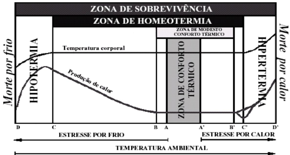
FIGURA 1 – Representação esquemática simplificada da zona de conforto térmico e suas delimitações. Adaptado de Curtis (1983).
