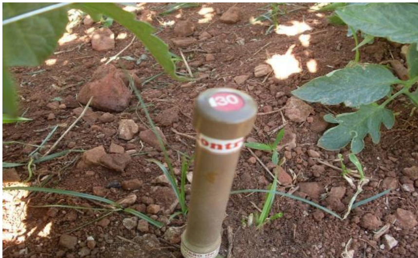
FIGURA 10 - Tensiômetro utilizado no experimento em Pirenópolis – 2011.
