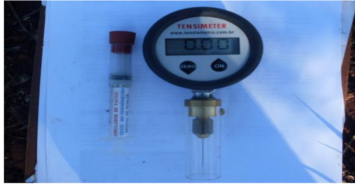
FIGURA 11 - Tensímetro utilizado no experimento em Pirenópolis – 2011.
