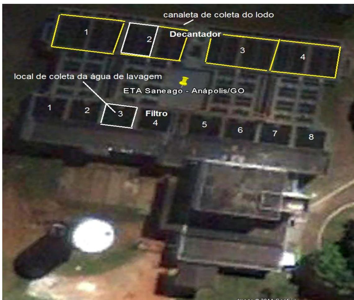
FIGURA 13 – Localização dos pontos de amostragem de lodo do decantador e água de lavagem de filtro.
