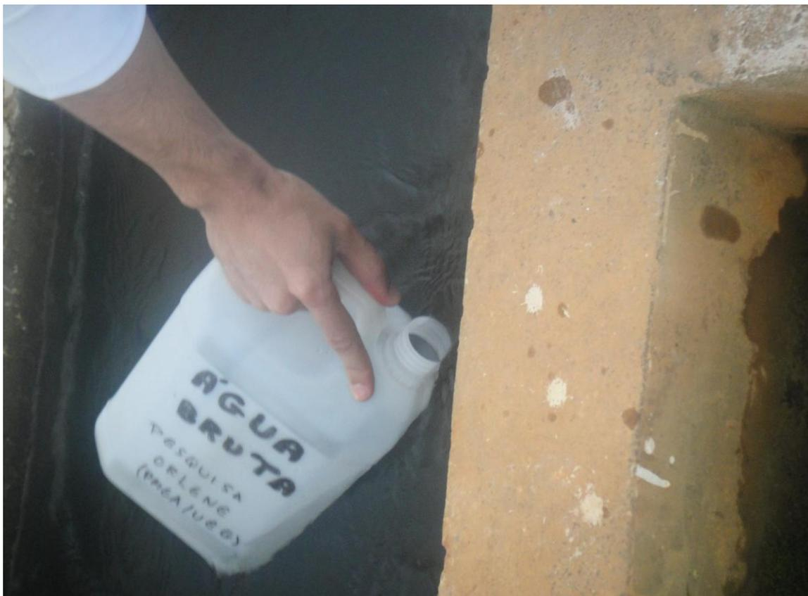
FIGURA 15 – Amostragem da água bruta na câmara de recepção antes da dosagem da cal hidratada.
