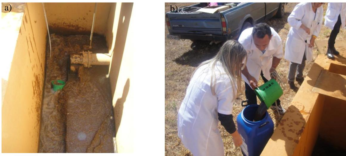
FIGURA 16 – Amostragem composta de lodo via descarga de fundo do decantador. (a) Coleta de lodo na canaleta lateral dos decantadores. (b) Formação da amostra composta de lodo em tambor de polietileno.
