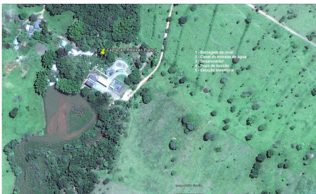
FIGURA 4 – Sistema de captação de água bruta do Ribeirão Piancó.
