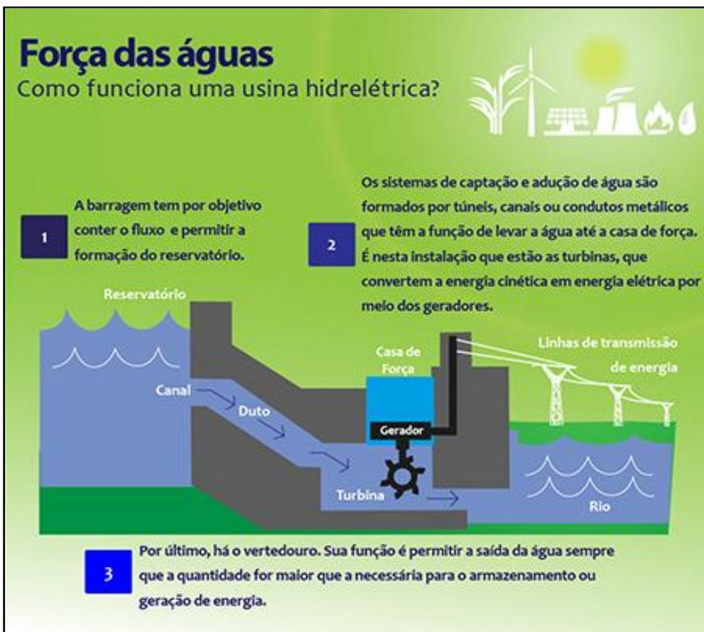
FIGURA 21: ESQUEMA DE UMA USINA HIDRELÉTRICA COM SEUS PRINCIPAIS ELEMENTOS.
