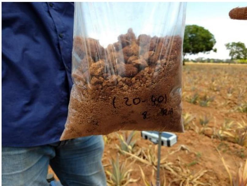
FIGURA 20 – Amostra deformada de solo identificada e armazenada em saco plástico.
