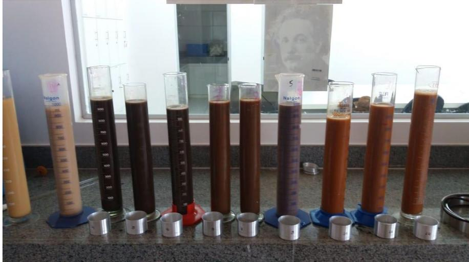
FIGURA 22 – Determinação granulométrica pelo método da pipeta.
