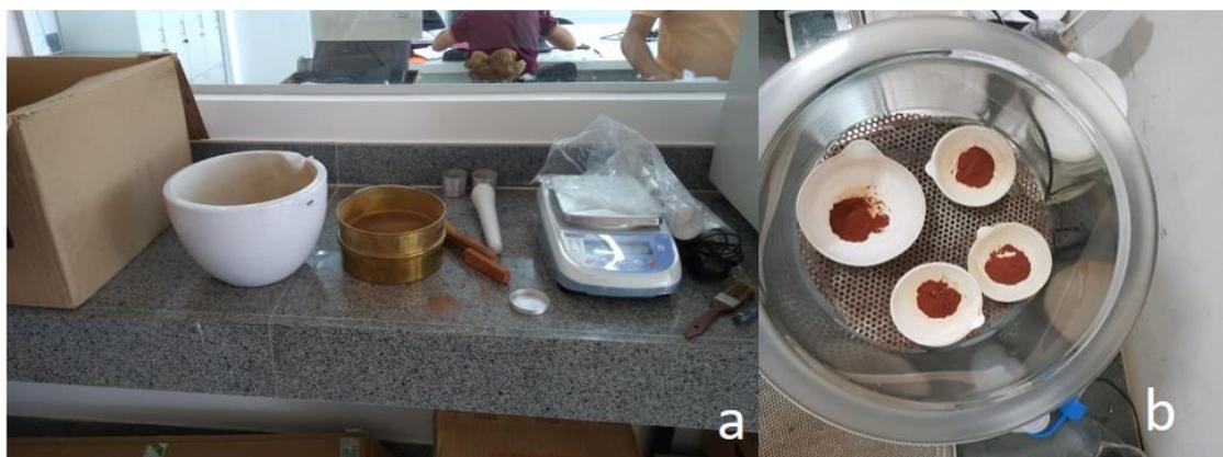
FIGURA 24 – a) Preparação da amostra de solo para análise de matéria orgânica (MO); b) resfriamento (em dessecador) da amostra após passar pelo ensaio de MO.
