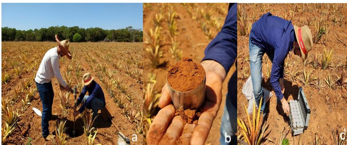
FIGURA 19 – a) Coleta de solo das amostras indeformada; b) anel volumétrico com amostra de solo; c) estojo transportador onde as amostras ficaram armazenadas.
