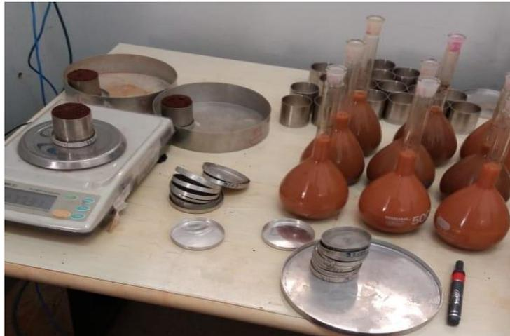
FIGURA 23 – Determinação da densidade de partículas e densidade do solo.
