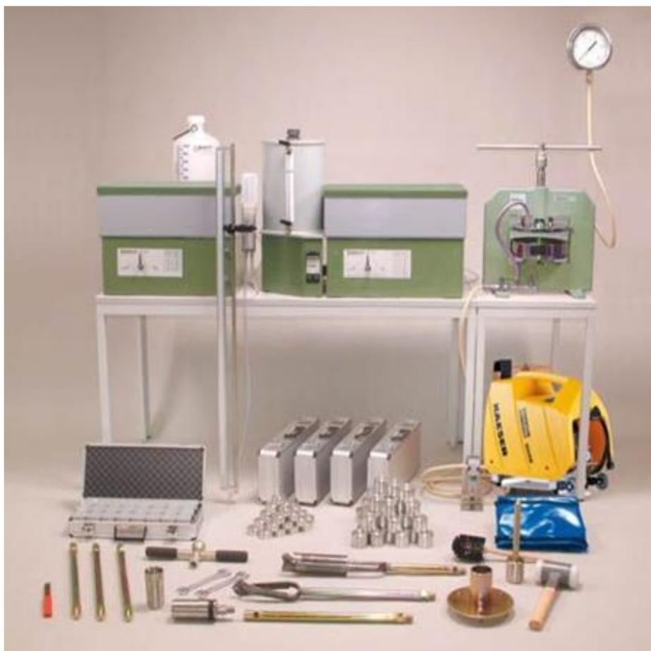
FIGURA 8 – Conjunto para determinação da curva de retenção de água no solo – Mesa de Tensão + extrator de membrana.
